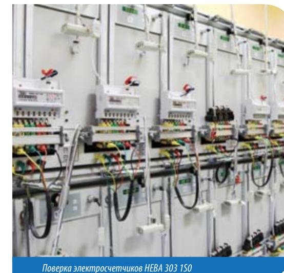
Проверка электросчетчиков HEBA 303 1S0
