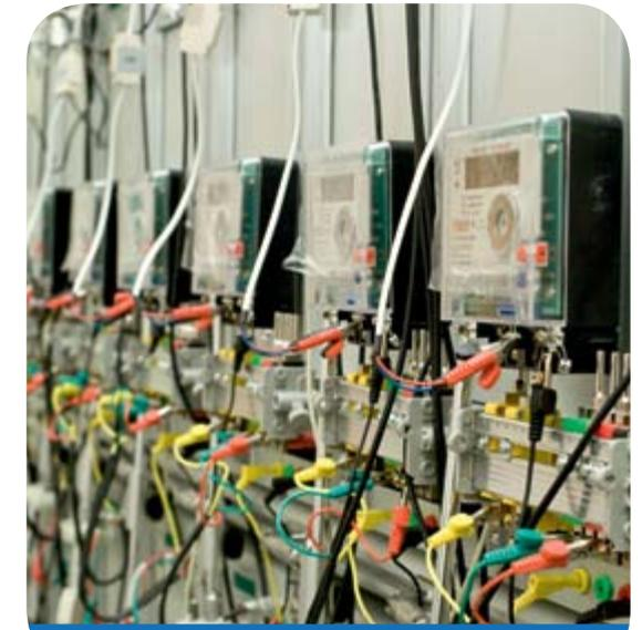
Проверка счетчиков электрической энергии НЕВА
