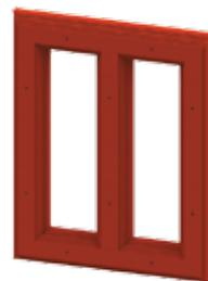
Изготавливается из листовой холоднокатаной электротехнической стали толщиной 0,27 мм с жаропрочным покрытием. Технология резки стали и схема шихтовки «step-lap» обеспечивает малые значения потерь и тока холостого хода. Увеличенная площадь сечения обеспечивает стабильную работу сухих трансформаторов в режиме перегрузки.
