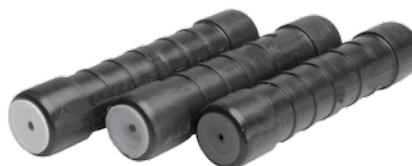
Электрический контакт обеспечивается опрессовкой, а герметичность – эластомерным кольцом. Прочность заделки 95% от прочности жилы. Имеют изолированный корпус. Заполнены контактной смазкой.
