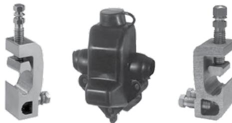
Зажим OCD 71B может применяться для повторного заземления неизолированной несущей нулевой жилы СИП-1. Зажимы различаются количеством ответвлений – зажим OCD 71B предназначен для одного ответвления, зажим OCD 72B – для двух ответвлений из одной точки. Контактные части зажимов смазаны специальной консистентной смазкой; Зажимы изготовлены из алюминиевого сплава. В комплекте с зажимами поставляется специальный влагозащитный чехол.
