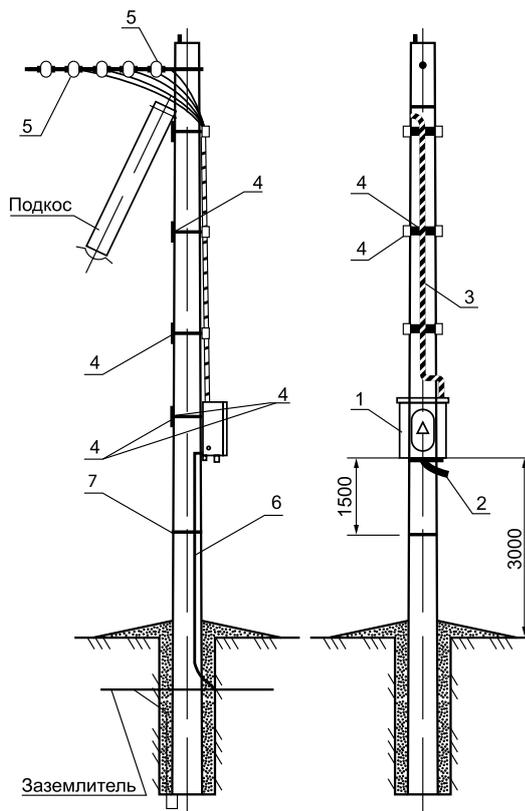
Пример установки УЗС ВЛИ на опоре
