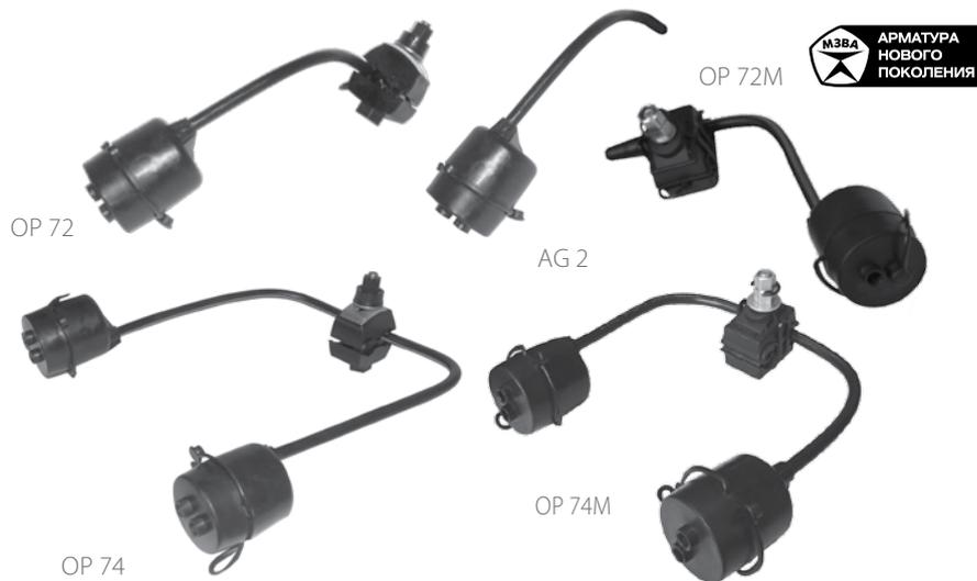
Срыв головки болта, обеспечивающего установку зажима на магистральный провод, соответствует эквивалентному усилию, необходимому для создания электрического контакта с проводом магистрали. На прокалывающие элементы нанесена контактная смазка. Зажим легко устанавливается на провод, отсутствуют выпадающие компоненты. Болт, обеспечивающий установку зажима на магистральный провод, изолирован от контактных деталей зажима.
