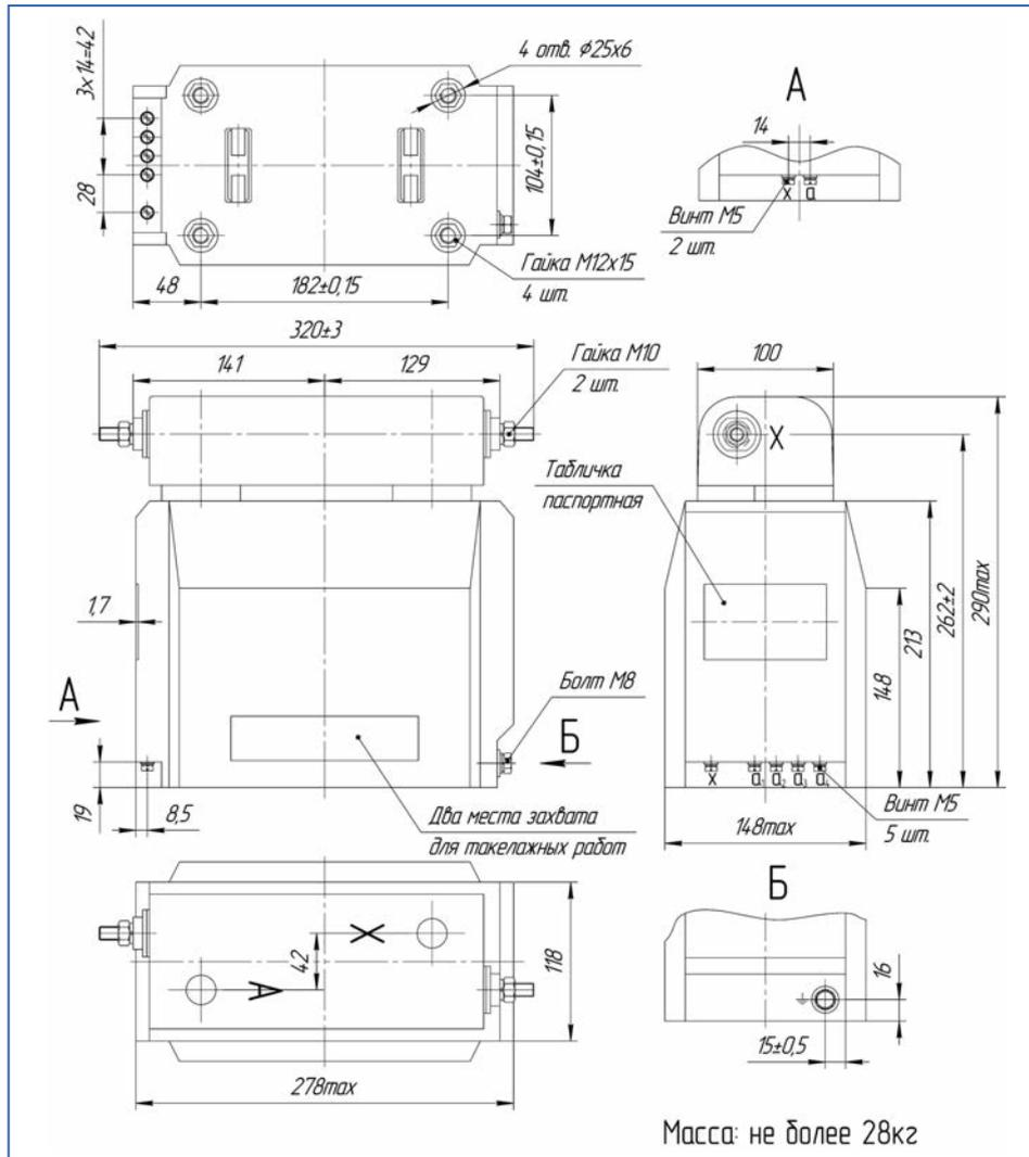
Габаритные, установочные и присоединительные размеры трансформаторов ОЛС-СЭЩ<sup>®</sup>-0,63/6(10)-11
