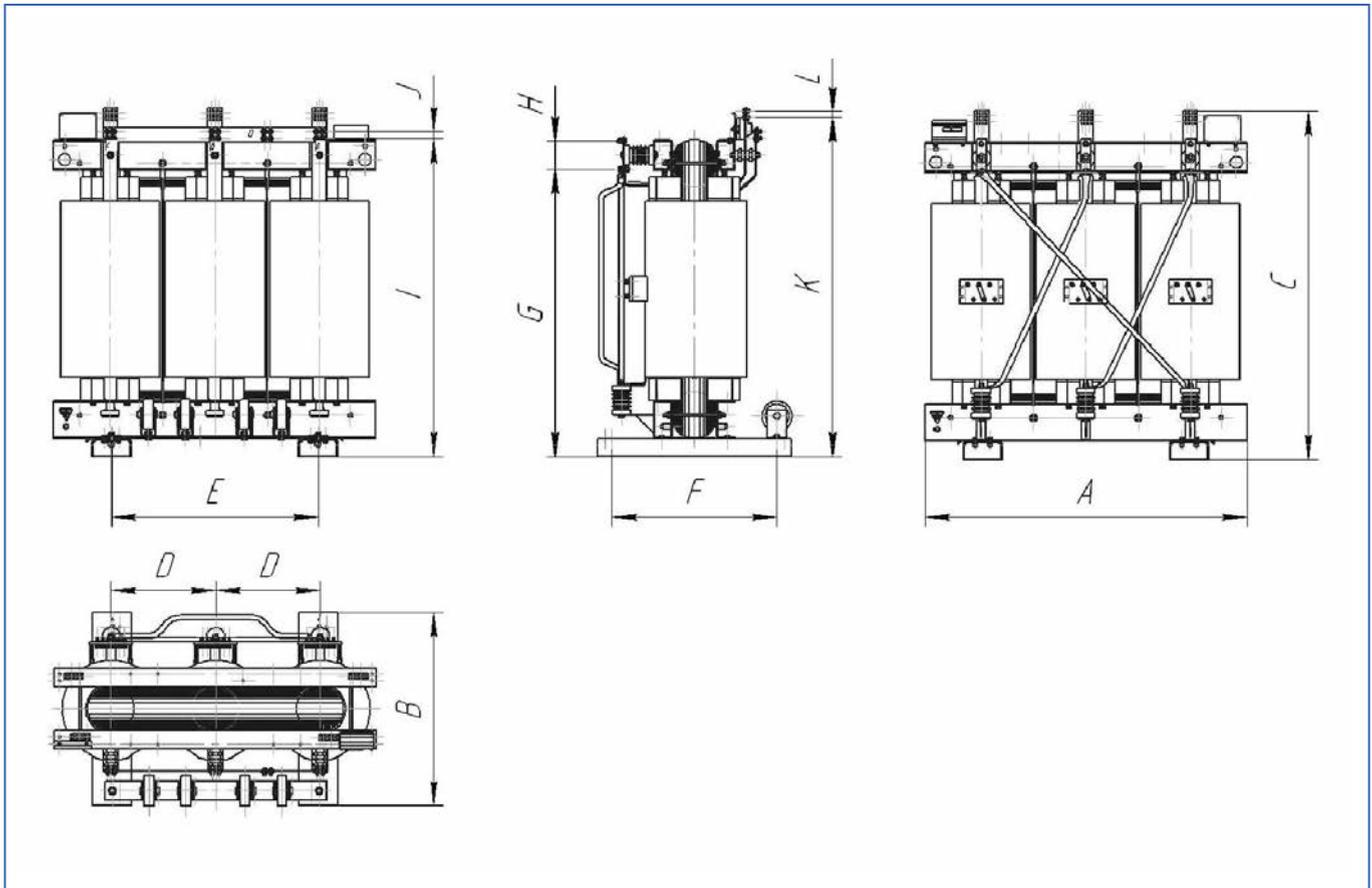
Габаритные, установочные и присоединительные размеры трансформаторов типа ТС классов напряжения 10 и 6 кВ
