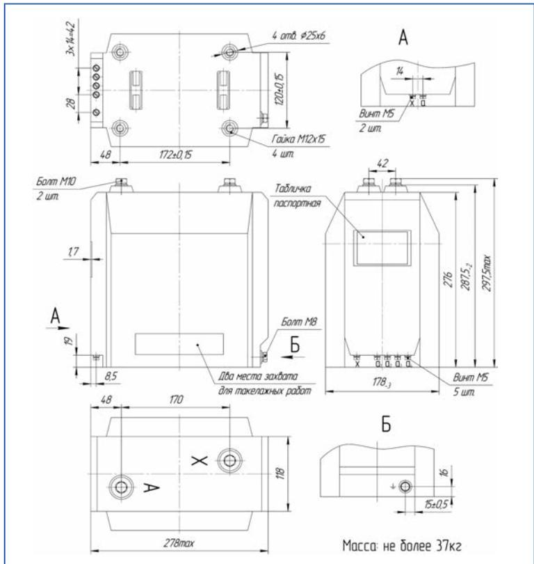
Габаритные, установочные и присоединительные размеры трансформаторов ОЛС-СЭЩ<sup>®</sup>-1,25/6(10) У(Т)2.
