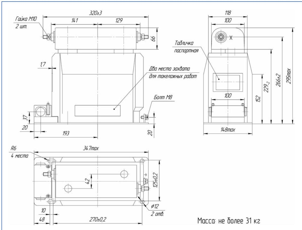
Габаритные, установочные и присоединительные размеры трансформаторов ОЛС-СЭЩ<sup>®</sup>-0,63/6(10)-1 У(Т)2.
