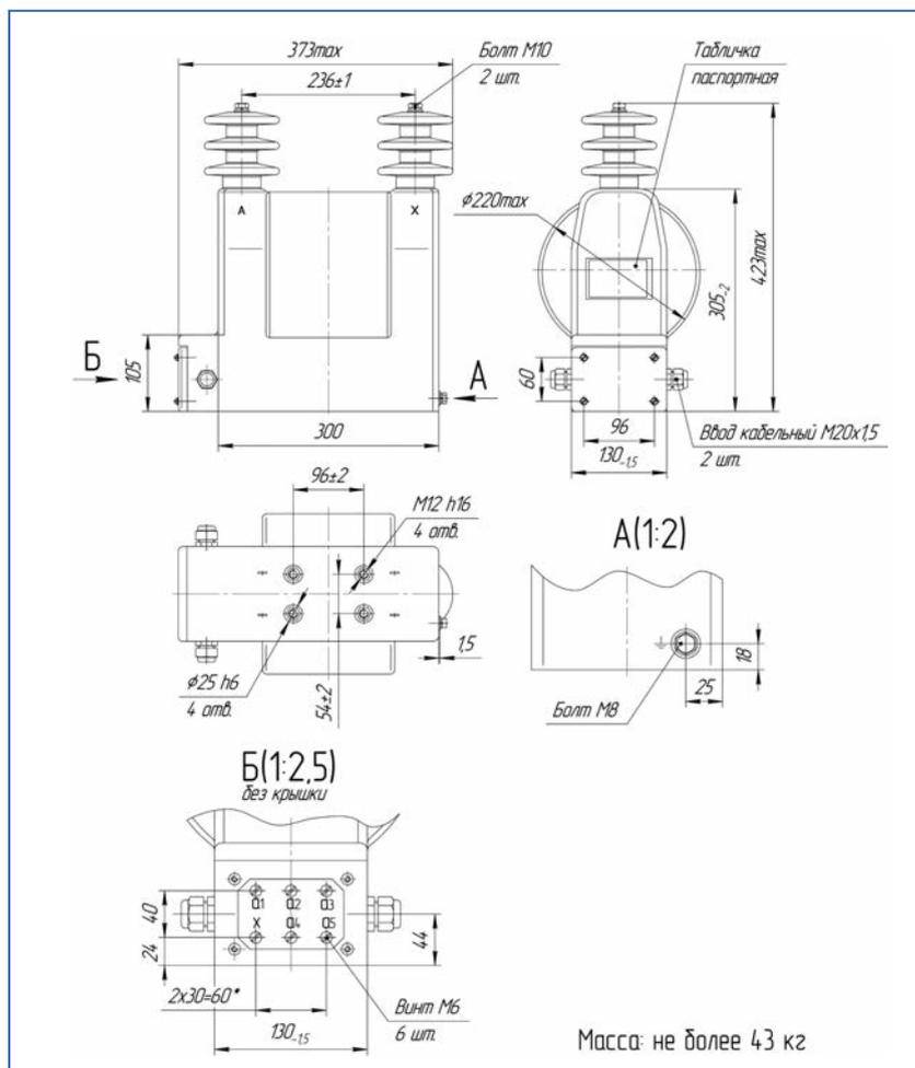
Габаритные, установочные и присоединительные размеры трансформаторов ОЛ-СЭЩ<sup>®</sup>-0,63/6(10) УХЛ (Т)1 и ОЛ-СЭЩ<sup>®</sup>-1,25/6(10)УХЛ (Т)1
