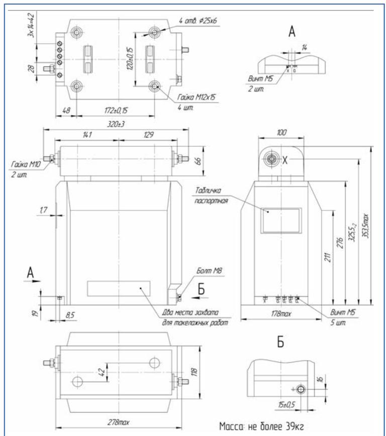
Габаритные, установочные и присоединительные размеры трансформаторов ОЛС-СЭЩ<sup>®</sup>-1,25/6(10)-1 У(Т)2.
