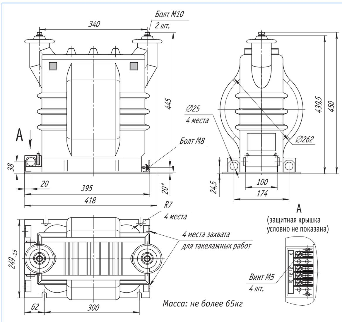
Габаритные, установочные и присоединительные размеры трансформаторов
